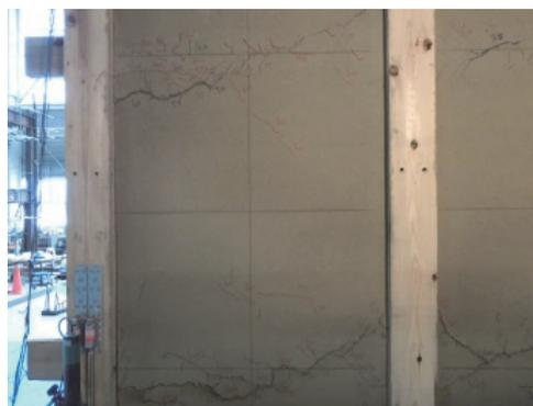
写真1 Type3-3 損傷状態(内壁面)
