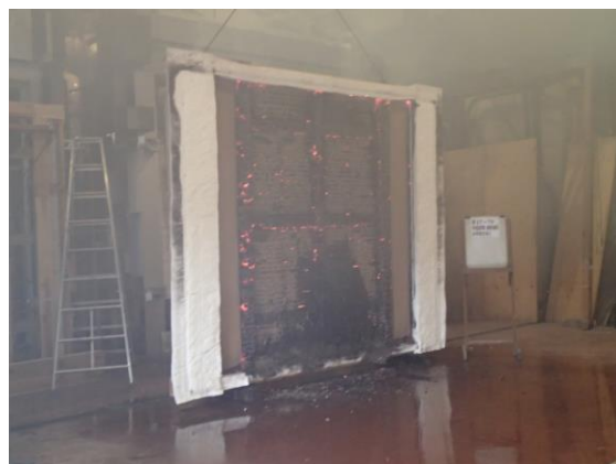
写真3 加熱実験終了後の様子
