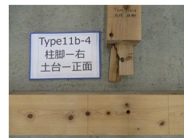
写真3 ほぞのせん断破壊
