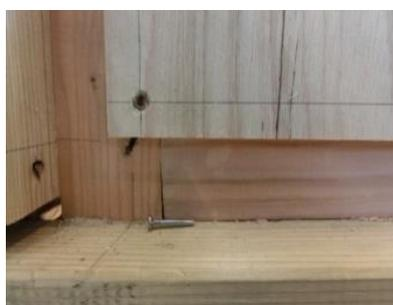
写真1 面材釘の破断
