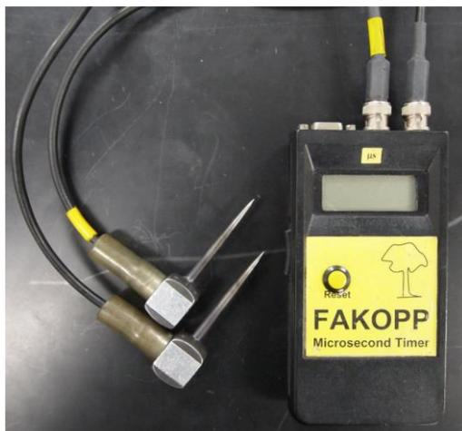
図1 応力波伝播時間測定装置
