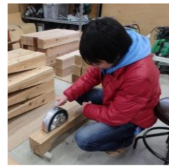
写真3 シュミットハンマーによる検証の様子
