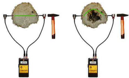
図1 応力波の伝搬経路のイメージ 3)
